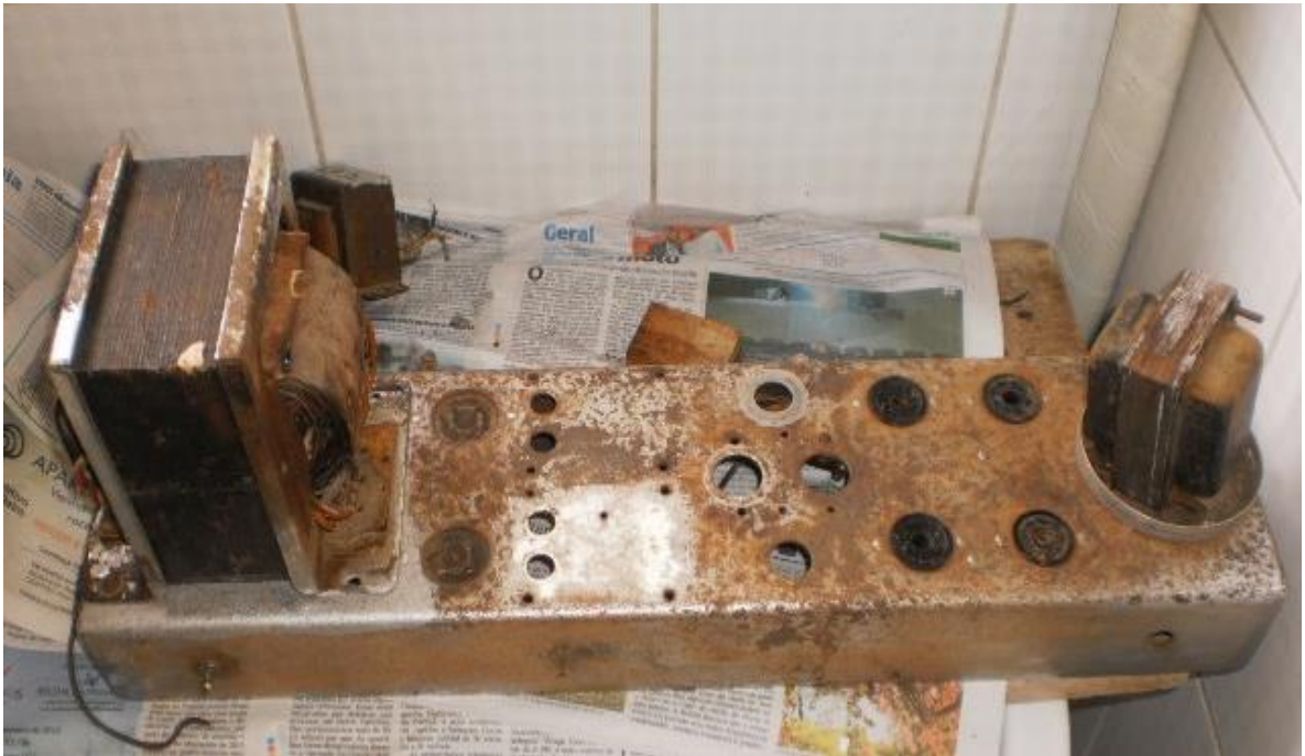
O chassi de retificação, saída com push-pull duplo e transformador driver.
