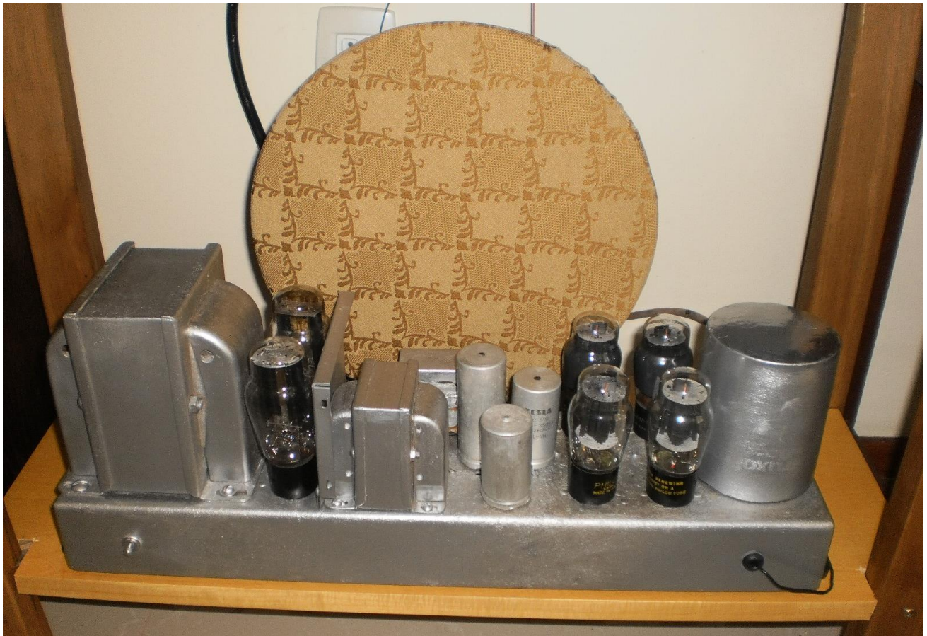
O chassi de retificação. Atrás, o conjunto alto-falante, transformador de saída e choque de filtro.
