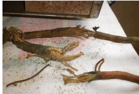
O estado do cabo de ligação entre o chassi receptor e o do alto-falante.
