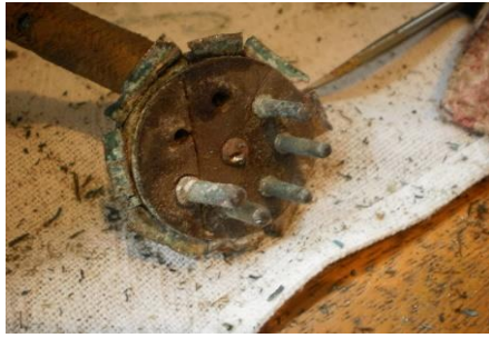
O estado do cabo de ligação entre o chassi receptor e o do alto-falante.
